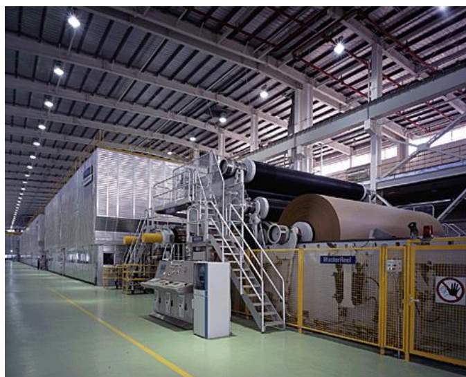
Fig. 2.5 - Seção de enrolamento em uma máquina de papel - Disponível em < http://www.tappi.org/content/Images/enewsletters/ecorr/scllarge.gif >
